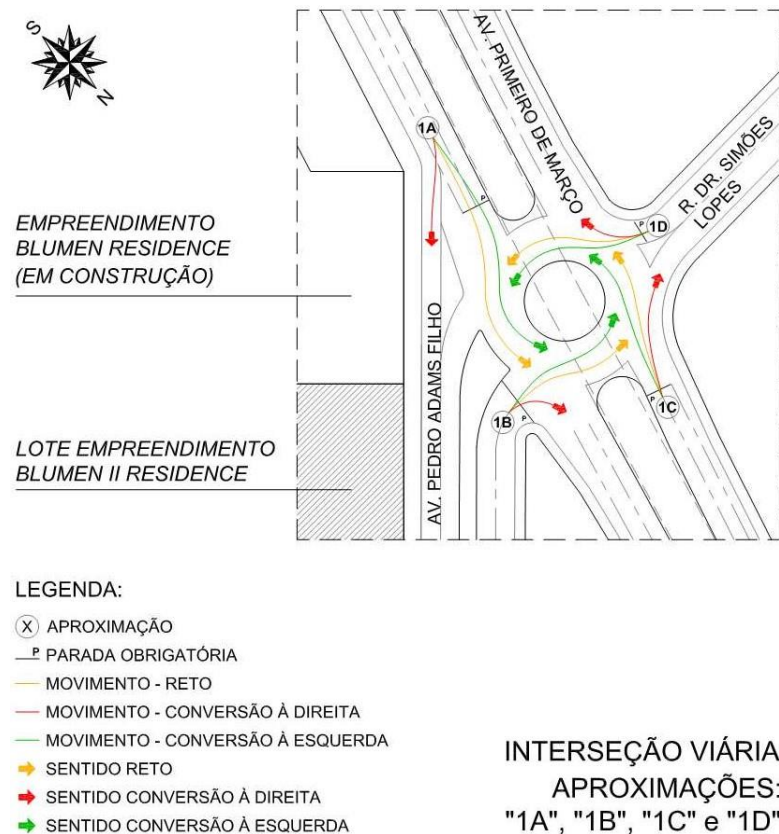
Figura 5: Esquema sentido dos fluxos interseção viária.
