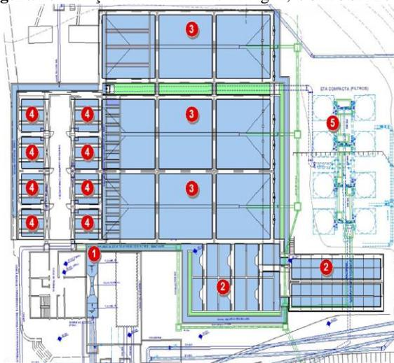
1 – Calha Parshall 2 – Floculadores 3 – Decantadores 4 - Filtros de areia 5 - ETA compacta desativada
