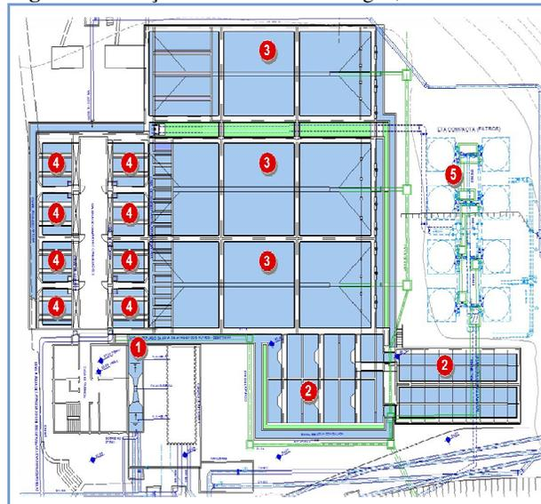
1 – Calha Parshall 2 – Floculadores 3 – Decantadores 4 - Filtros de areia 5 - ETA compacta desativada
