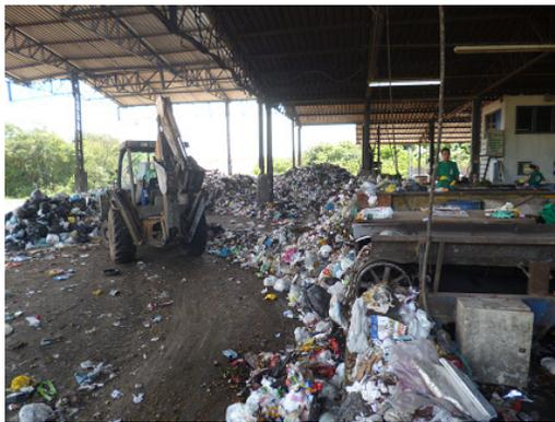
**Figura 14.** Carregamento dos rejeitos em caminhão transportador com auxílio de equipamento mecânico (retroescavadeira).
