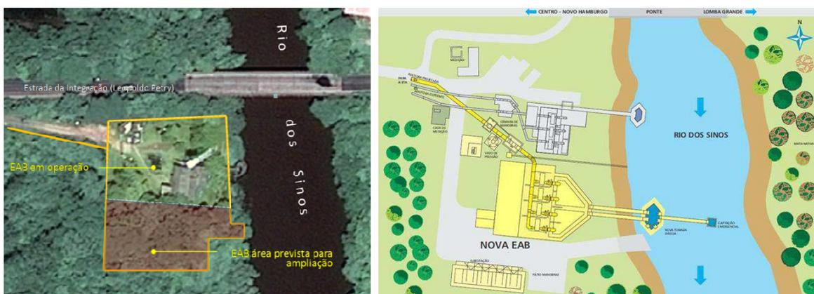
Figura 3 - EAB em operação e nova captação projetada
